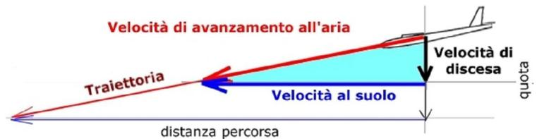
In nero, la velocità di discesa: ovvero la velocità con cui il modello perde quota (negli aerei si chiama velocità variometrica)
