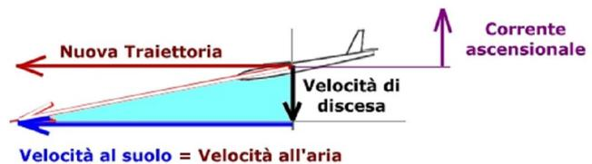
**Se il modello incontra un vento frontale uguale alla velocità di avanzamento al suolo**, il vento annulla l'avanzamento ed il modello vola fermo sul posto, scendendo verticalmente. Ecco allora l'importanza del fattore meteorologico vento, che gioca un ruolo fondamentale nel volo del modello.
